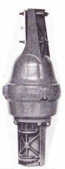
THE HEAVY DUTY - HAM-II....98 BALL BEARINGS, STEEL GEARS, POSITIVE LOCKING BRAKE..(29 LB).
